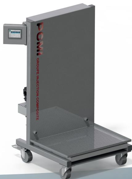
La station GSS PT01, est un équipement simple de conception pour la mise en œuvre de résine mono-composant en projection ou en injection. Châssis en T, écran tactile de 7" avec installation des programmes de fonctionnement, possibilité d'évolution dans son aménagement (soit par le client soit en commandant les options figurant sur le tableau). Châssis en mécano soudé, peinture époxy, bac de rétention.
