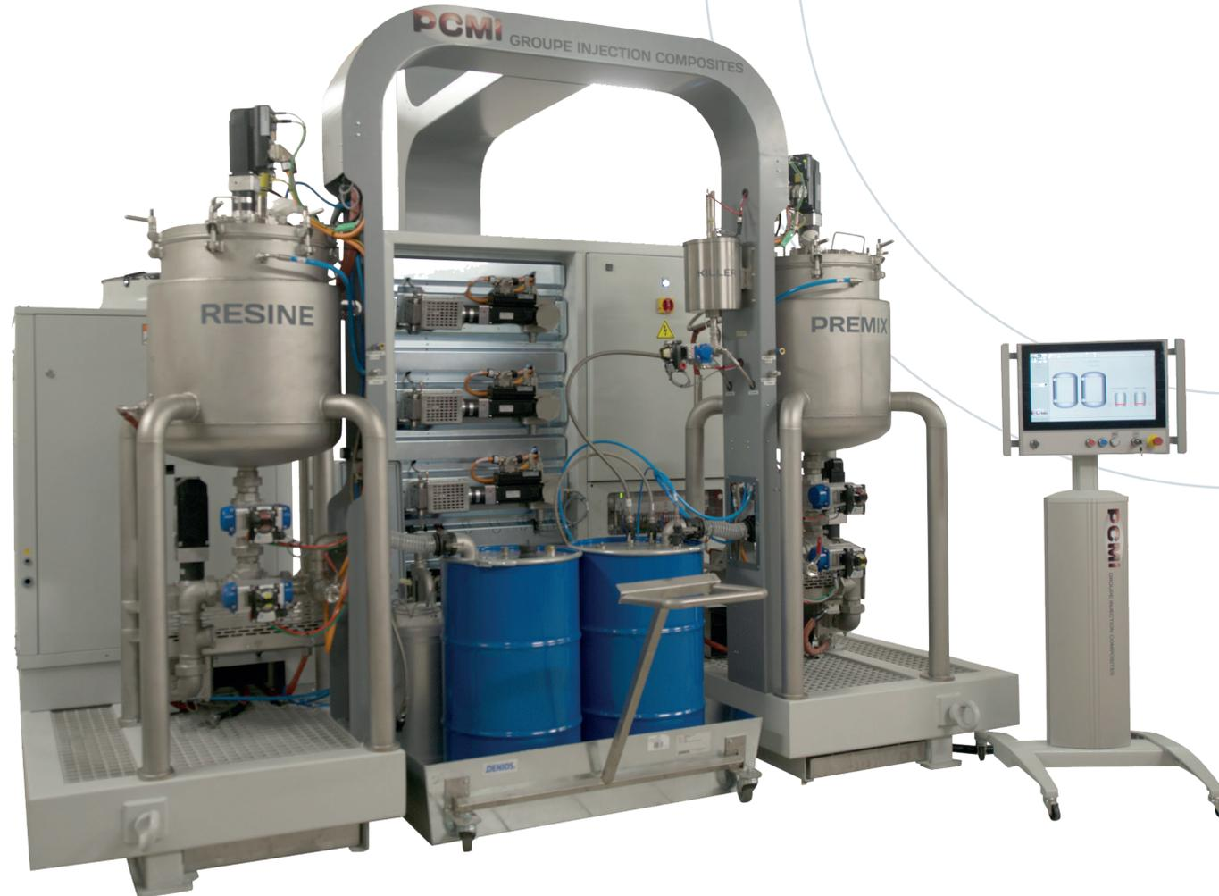
La machine GSS IN09 est une machine spécialement conçue pour l'injection des résines ELIUM avec les dernières technologies dans la précision de l'injection et dans l'acquisition des données, pompes à engrenages avec débitmètres, pour la régularité dans le dosage.
