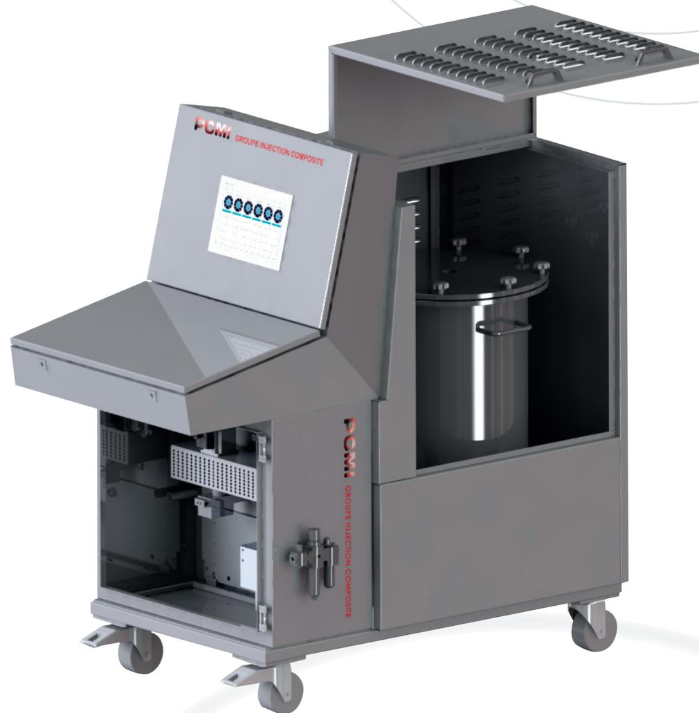
Les machines GSS IN04 et GSS IN05 sont des machines de nouvelles générations pour le RTM. Pupitre de commande largeur 900 fixé sur un châssis mécano soudé, peinture époxy et bac de rétention (en option carénage). Ecran tactile de 15" relié à une commande numérique optimise les paramètres d'injection (quantités, plage de débit résine et de durcisseur, pourcentage de durcisseur, pression, temps d'injection et recettes).
