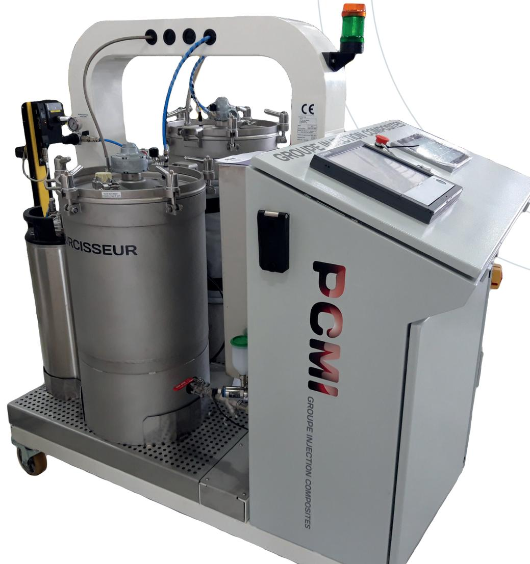
Machine d'injection spécialement conçue pour l'injection des résines époxy en petit débit, avec les dernières technologies dans la précision et dans l'acquisition des données.
